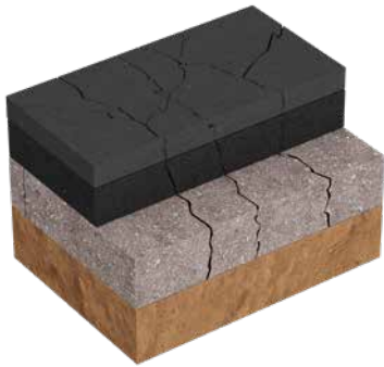
Gerissener Belag ohne S&P Asphaltbewehrung
