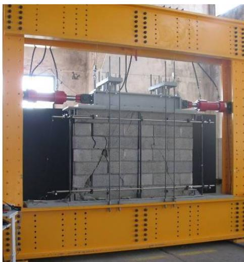
Image 20: banc d'essai à EIA Fribourg
