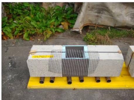
Image 3 : éprouvette en béton avant essai
