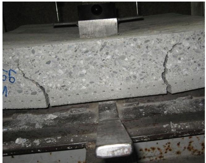
Image 8: Echantillon VSH à la rupture
