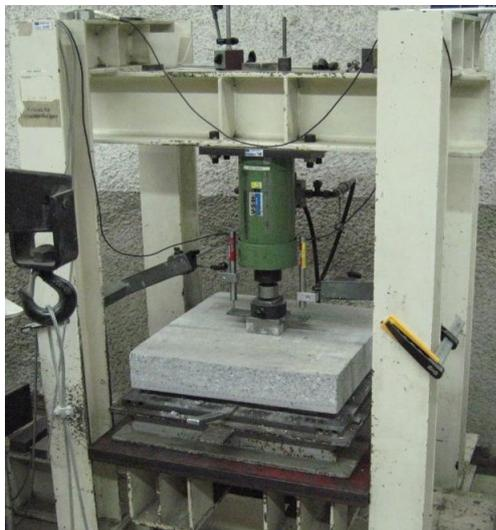
Image 7: Disposition de l'essai VSH
