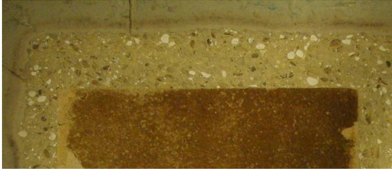
Image 33: pas d'éclatement en cas de béton fibré avec des fibres PP
