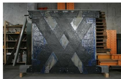
Images 21, 22, 23: Dispositions différentes des C-Sheet 240 S&P
