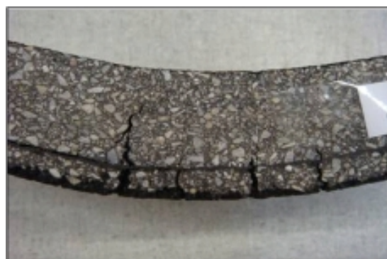
Photo 3 : Essai avec couche S&P Carbophalt G 200 kN
