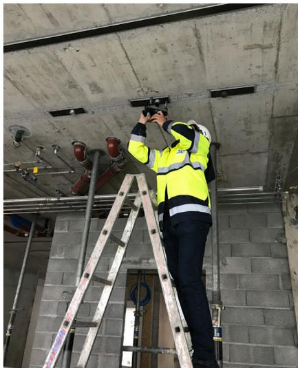
▲ Essais d'arrachement en cours par un spécialiste S&P pour vérifier la qualité du collage des lamelles S&P C-Laminate
