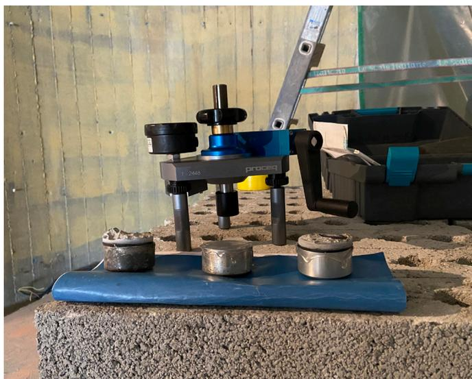
▲ 3 pastilles arrachées devant l'appareil de mesure
