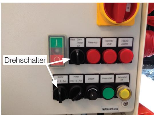
Vor Ende der Spritzarbeiten den Drehschalter «Mischer» auf «0» stellen und den Drehschalter auf «Überbr. Trockenlauf» stellen um das restliche Material aus dem Nachmischbehälter zu pumpen bis die Förderwelle zu sehen ist.
