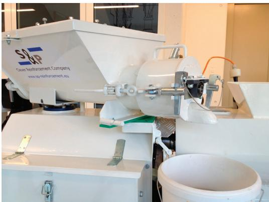
Mischwerk zur Seite drehen und mindestens einen Kübel Mörtel auslassen bis das Material eine konstante, homogene Konsistenz hat. Mit dem Handrad kann der Mörtel auf die gewünschte Wassermenge korrigiert werden. Anschliessend das Mischwerk wieder über den Nachmischbehälter positionieren.
