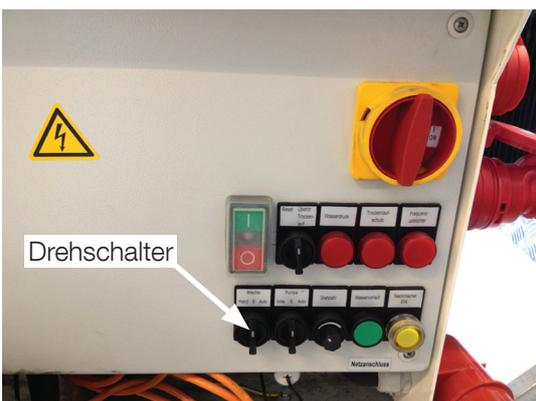
Den Drehschalter «Mischer» auf «Auto» stellen und warten bis der ganze Nachmischbehälter voll ist. Das Mischwerk stellt automatisch ab sobald der Mörtel die Sonde erreicht.
