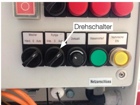
Drehschalter «Pumpe» auf «Auto» stellen. Nun kann die Maschine an der Spritzdüse an- und abgeschaltet werden. Luft auf: Maschine beginnt zu fördern, Luft zu: Maschine unterbricht Förderung.
