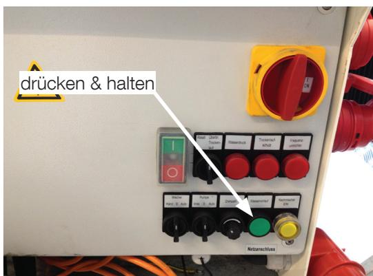
Knopf «Wasservorlauf» drücken und halten, mit Handrad die gewünschte Wassermenge einstellen.
