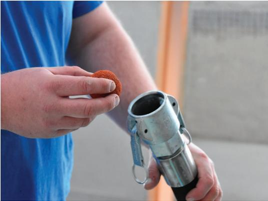
Nun können die Maschine und die Materialschläuche gereinigt werden. Jeder Schlauch ist einzeln zu reinigen und muss mindestens 2 Mal mit den Reinigungsbällen durchgestossen werden.
