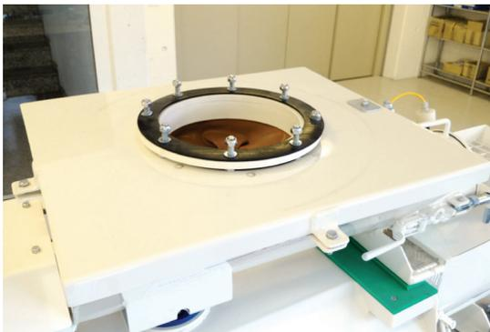
Für Siloware: Beschickung direkt via Kupplungselement in Vorratssilo (keine Staubentwicklung)
