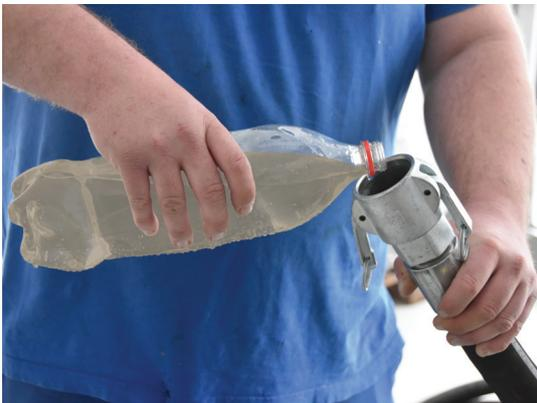
Vor dem Start der Materialförderung muss eine Schmiermischung in die Materialschläuche gegeben werden! Dies kann eine Zementschlämme sein, wir empfehlen jedoch Fischkleister zu verwenden.
