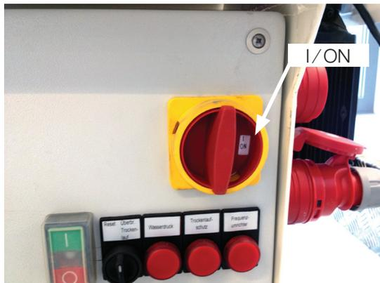
Hauptschalter der Maschine auf I/ON drehen.
