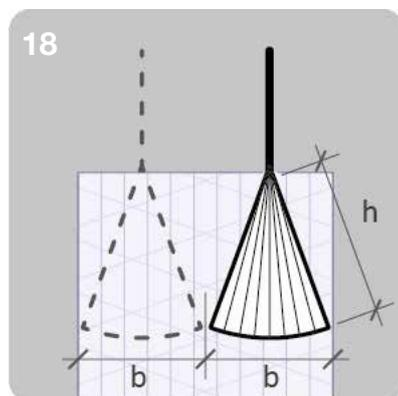
18. Appliquer frais sur frais la partie flexible en éventail du S&P C-Anchor sur le tissu S&P C-Sheet.
