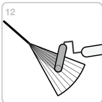
12. Imprégner les fibres de la partie flexible en éventail avec la S&P Resin 55 HP en utilisant le rouleau de marouflage S&P et la spatule en caoutchouc S&P. Une saturation complète des fibres doit être obtenue.
