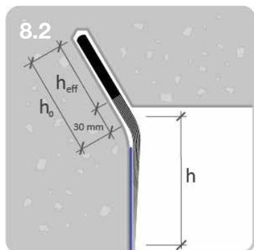
8.2. La partie flexible en éventail doit être 30mm plus longue que la longueur des fibres à stratifier sur le S&P C-Sheet:  $h_{fan} = h + 30\text{mm}$ .
