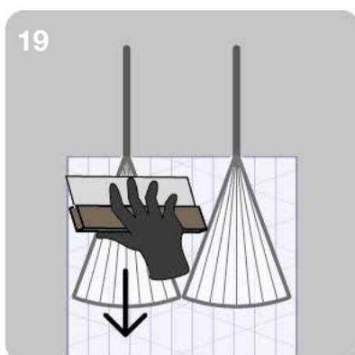
19. Étaler uniformément la résine et stratifier les fibres de carbone du S&P C-Anchor à l'aide de la spatule en caoutchouc S&P. Le mouvement de stratification doit se faire à partir du perçage et uniquement dans la direction des fibres.
