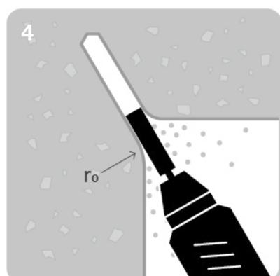
4. Avant l'application du S&P C-Anchor, il est nécessaire d'arrondir les angles saillant du support pour assurer la transmission des efforts entre la partie pre-durci en usine et la partie de fibres flexibles en éventail.
