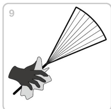
9. Nettoyer et dégraisser la partie pre-durci en usine du S&P C-Anchor à l'aide d'un chiffon propre et du S&P Cleaner.
