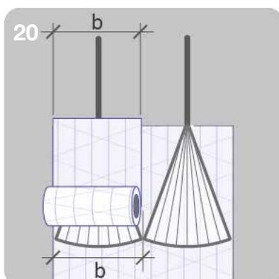
20. Disposer frais sur frais un recouvrement de tissu S&P C-Sheet sur chaque partie flexible en éventail des S&P C-Anchor mis en place. Le recouvrement doit être disposé dans la même direction que les renforts S&P C-Sheet disposés préalablement.
