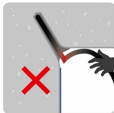
17. Insérer lentement la partie pre-durci en usine dans le perçage jusqu'à ce qu'elle touche le fond de celui-ci, afin de s'assurer que 30 mm de la partie flexible en éventail se trouvent à l'intérieur du trou.
