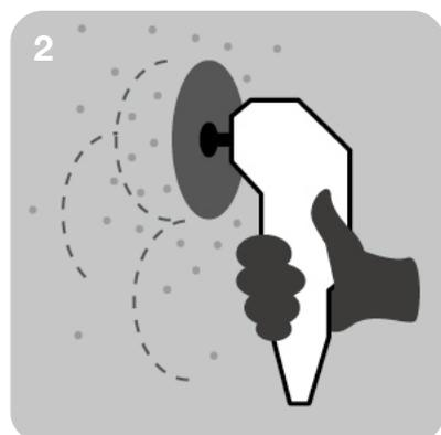
2. Préparer le support en béton pour l'application du tissu S&P C-Sheet.
