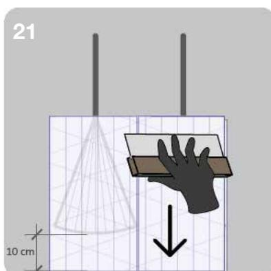
21. Étaler la résine uniformément avec la spatule en caoutchouc S&P avec un mouvement dans une seule direction : longitudinalement aux fibres.
